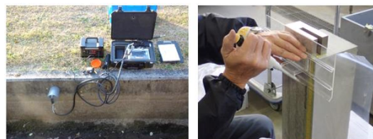
a) 表層透気試験 減圧後の圧力の回復挙動から 表層の透気性を調べる。 b) 流水試験 滴下した水の流下距離から表 層の品質を調べる。
